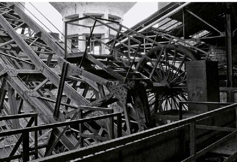
Amorce du plan incliné (partie supérieure - raillage du chariot contrepoids) et molette de renvoi du câble de contrepoids. Vue depuis l'intérieur du hall de préparation des charges.
